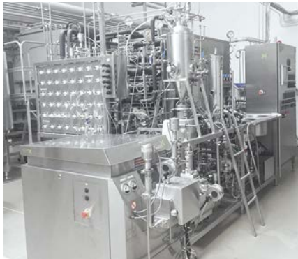
Der variable Aseptoerhitzer im Technikum von Lactoprot, das auch über die nötigen Laborkapazitäten verfügt (Fotos: Lactoprot)
